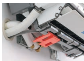
台枠固定爪(左)がクルッと畳める
