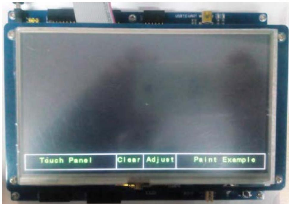
将 7inch Resistive Touch LCD 通过 40PIN 的 FFC 线接到 LCD 接口 1 上。
