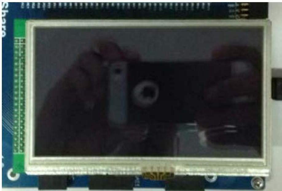
将 4.3inch 480x272 Touch LCD (B)模块插到 LCD 接口上。
