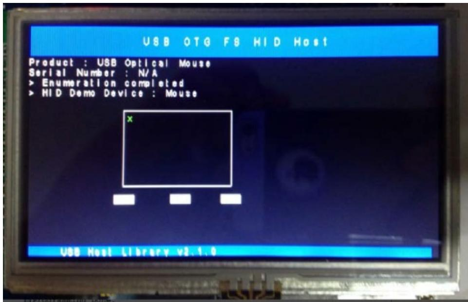
OTG 线一端接鼠标，另外一端接到板子上的 USB 接口。
