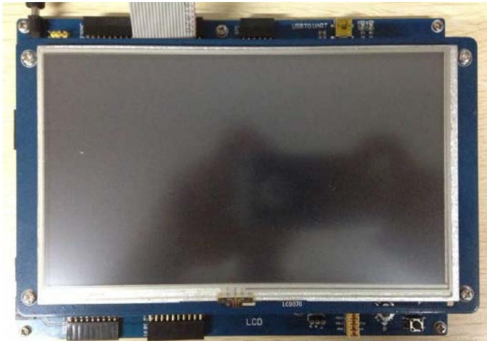
接入 7inch Capacitive Touch LCD 时，需要分别通过 40PIN 的 FFC 线连接 LCD 接口 1，以及通过 4PIN 的 FFC 线连接电容触摸屏接口。
